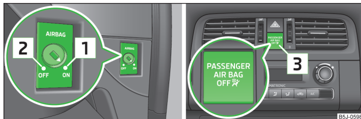
Илл. 12 Выключатель с замком для подушки безопасности переднего пассажира/контрольная лампа отключения/включения подушки безопасности переднего пассажира
