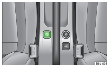
Илл. 135 Клавиша установки контрольных значений давления в шинах
